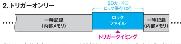
動画は、本体内部のメモリに一時記録されます。トリガー入力を受け付けると、トリガータイミングを中心とした、1つの動画ファイル (上書き禁止) を生成しSDカードに保存します (トリガーオンリー)。SDカードにはトリガー入力時のみの保存動作で、SDカードの長寿命化が期待できます。録画単位 (t2) の基本設定は、「20秒」「40秒」より選択できます。(トリガーが連続して入力された場合、1ファイル当たりの録画時間は延長されます。)
