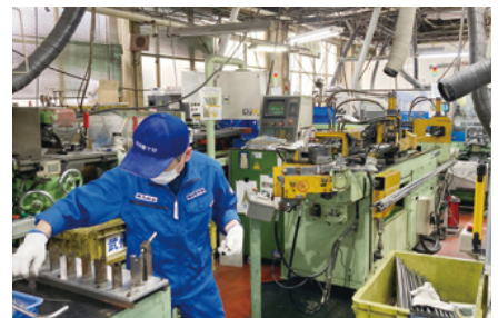
▲1人の多能工が全行程の生産を完結させる独自のシステム「1個流し生産ライン」
