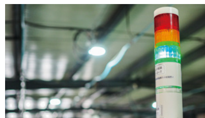
▲設備の稼働状況を見える化するパトライト信号灯
